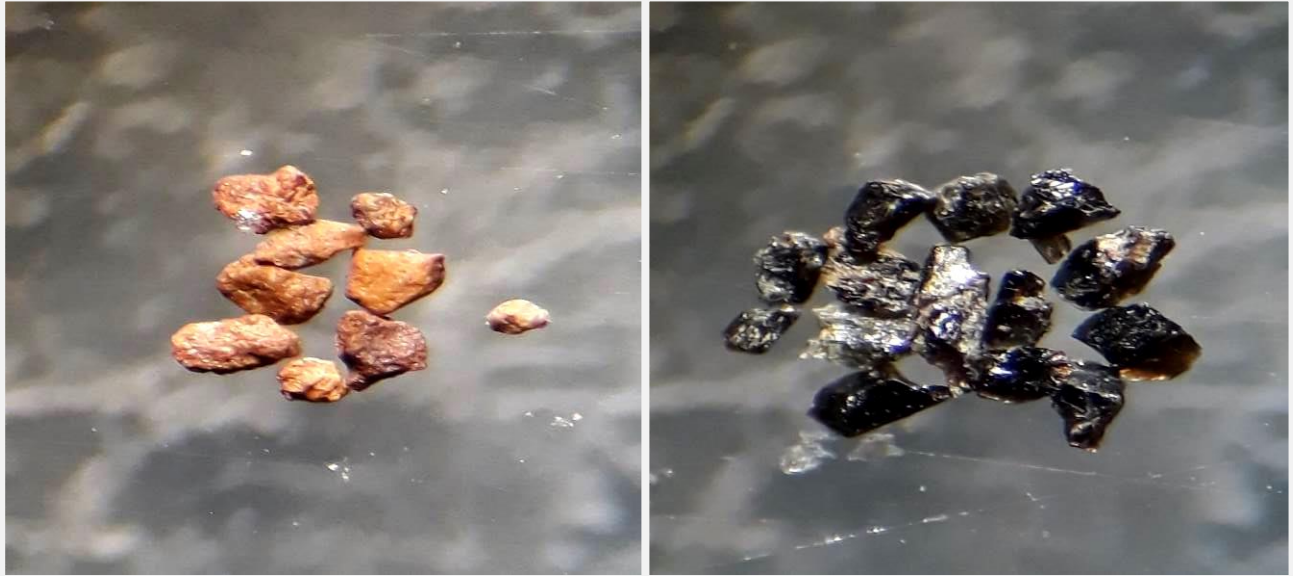
نگاره ۳. راست) نمایی از بلورهای آمفیبول در نمونه؛ ب) نمایی از دانه‌های لیمونیت در نمونه (میدان دید نگاره‌ها = ۳۰ میلی‌متر)
