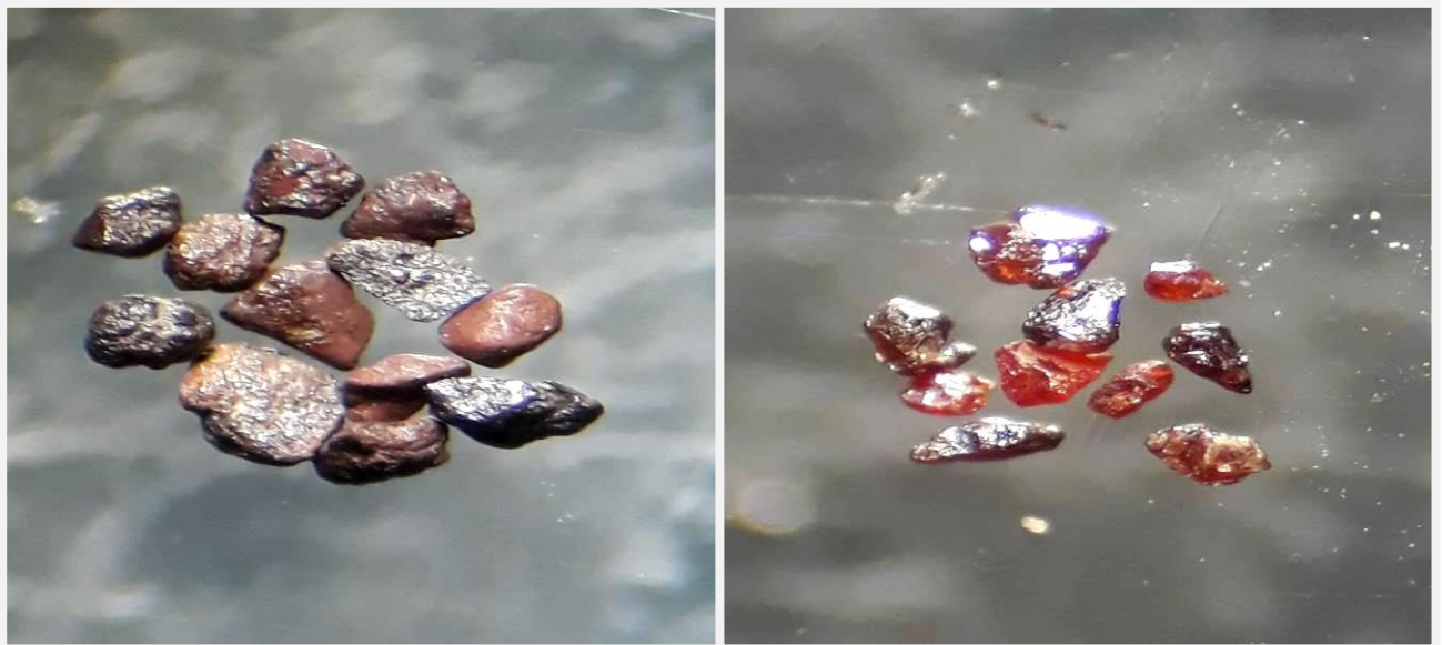
نگاره ۲. راست) نمایی از دانه‌های روتیل در نمونه (میدان دید = ۴۰ میلی‌متر)؛ چپ) نمایی از دانه‌های هماتیت در نمونه (میدان دید نگاره = ۳۰ میلی‌متر)
